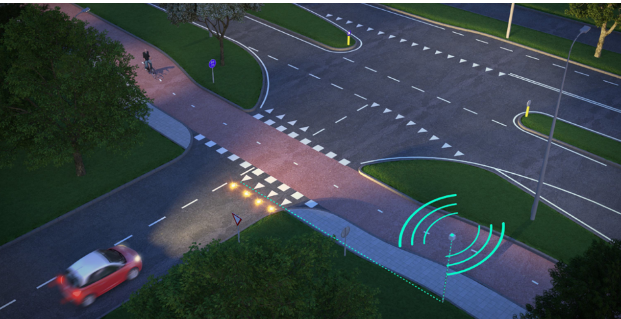
Signalering via LEDS in het wegdek Foto: Heijmans
